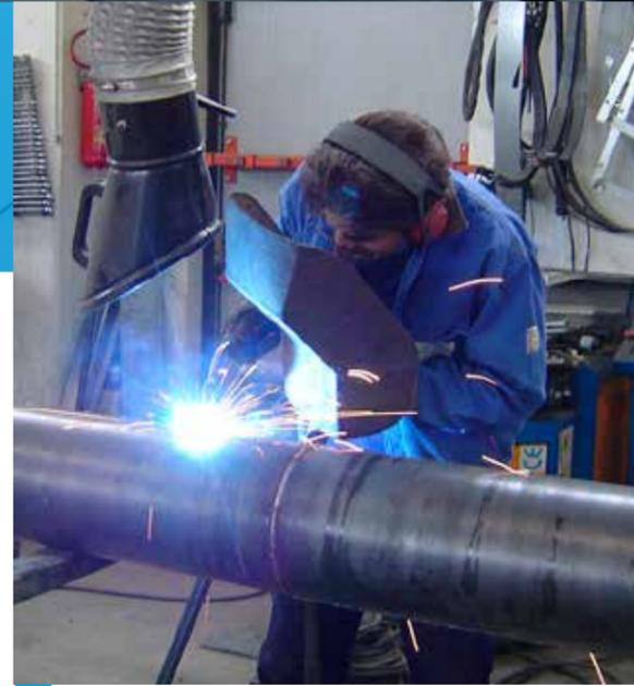
costruzione coclea di scarico per trucioli o pellet
