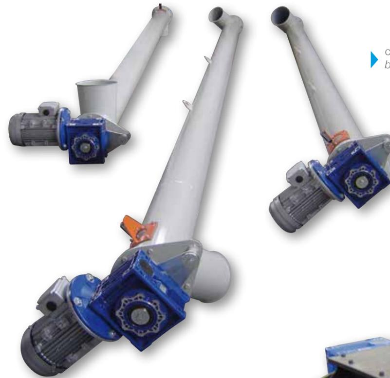
▶ coclee cilindriche per scarico trucioli di legno, polveri e pellet
