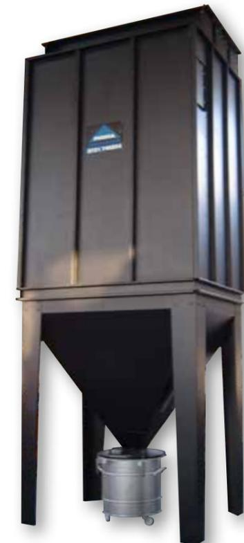
▶ filtro a lavaggio in contro corrente per fumi caldi prodotti da caldaia
