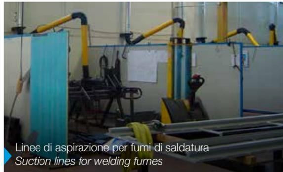
Linee di aspirazione per fumi di saldatura
