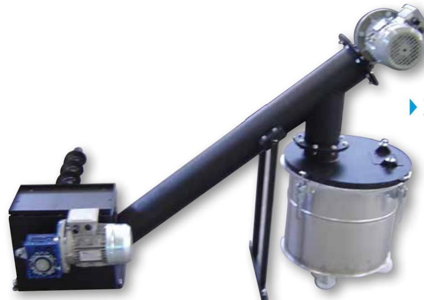
▶ coclea per scarico scorie caldaia
