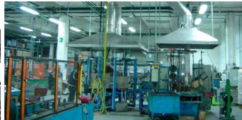
cappe inox per aspirazione fumi di saldatura a stagno
