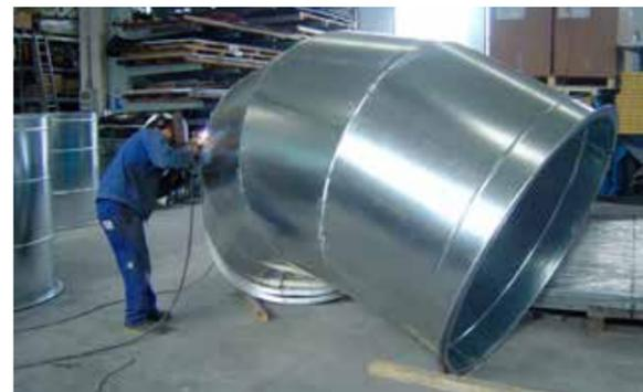
costruzione coclea di scarico per trucioli o pellet
