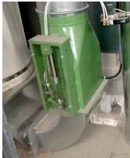
valvole pneumatiche/pneumatic valves
