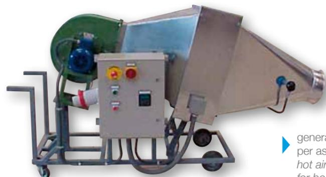
generatore di aria calda per asciugatura barche
